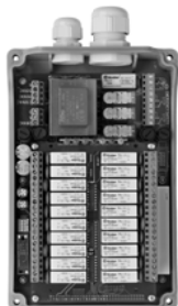
Type 'L' 20 x 12 Amp volt free relays
